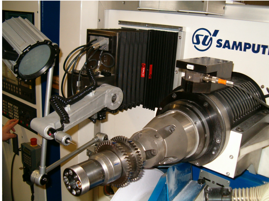
Figura N° 7 – Sonda montata su affilatrice mod. S400GS
