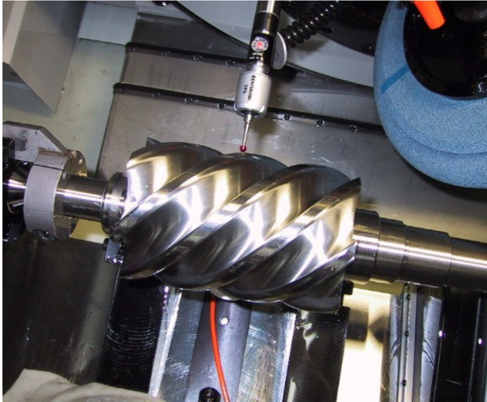
Figura N°9 – Controllo del profilo di un rotore su macchina mod.S375G
